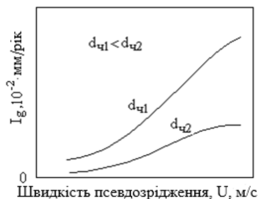
Рис. 4. Характер впливу швидкості псевдозрідження на інтенсивність ЗЕ
