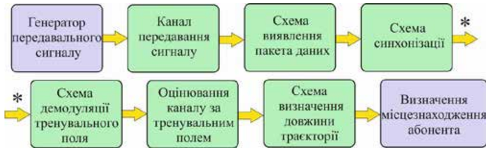
Рис. 6. Блок-схема обробки сигналу та визначення координат мобільної станції на основі трилатерації
