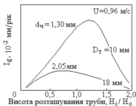
Рис. 7. Вплив відносної висоти розташування труби на інтенсивність ЗЕ
