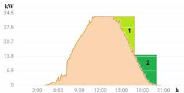
Рис. 3. Потенціал використання накопичувача енергії для зсуву генерації в часі: зона 1 – високопотужний інтервал, зона 2 – вечірній інтервал підтримки / компенсації
