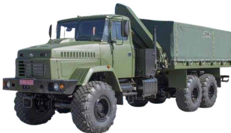
Рис. 3. Пересувна автотранспортна майстерня
