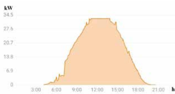
Рис. 2. Добовий профіль генерації у ясний день з характерною «полицею» на рівні АС-ліміту
